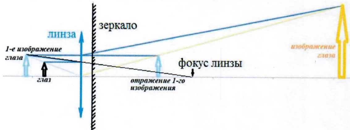
Рис. 1а. Ход лучей для линзы с большим фокусным расстоянием
